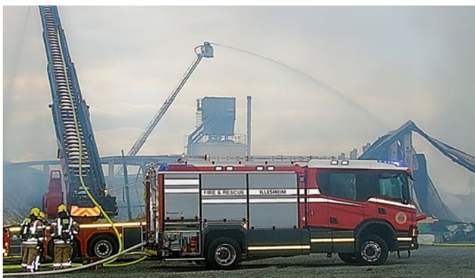
Militärfeuerwehr im Einsatz: Mit einem HLF 20 und einer DLK 23/12 unterstützt die US-Army-Feuerwehr aus dem benachbarten Illesheim. Die Arbeit ist nur mit PA oder Filtergeräten möglich.
